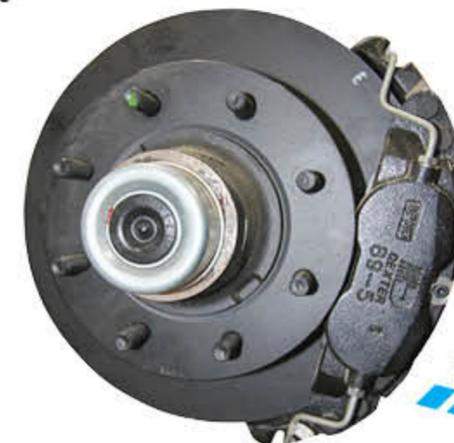
**FACTORY INSTALLED DISC BRAKE (OPTION)** ▲ 15
